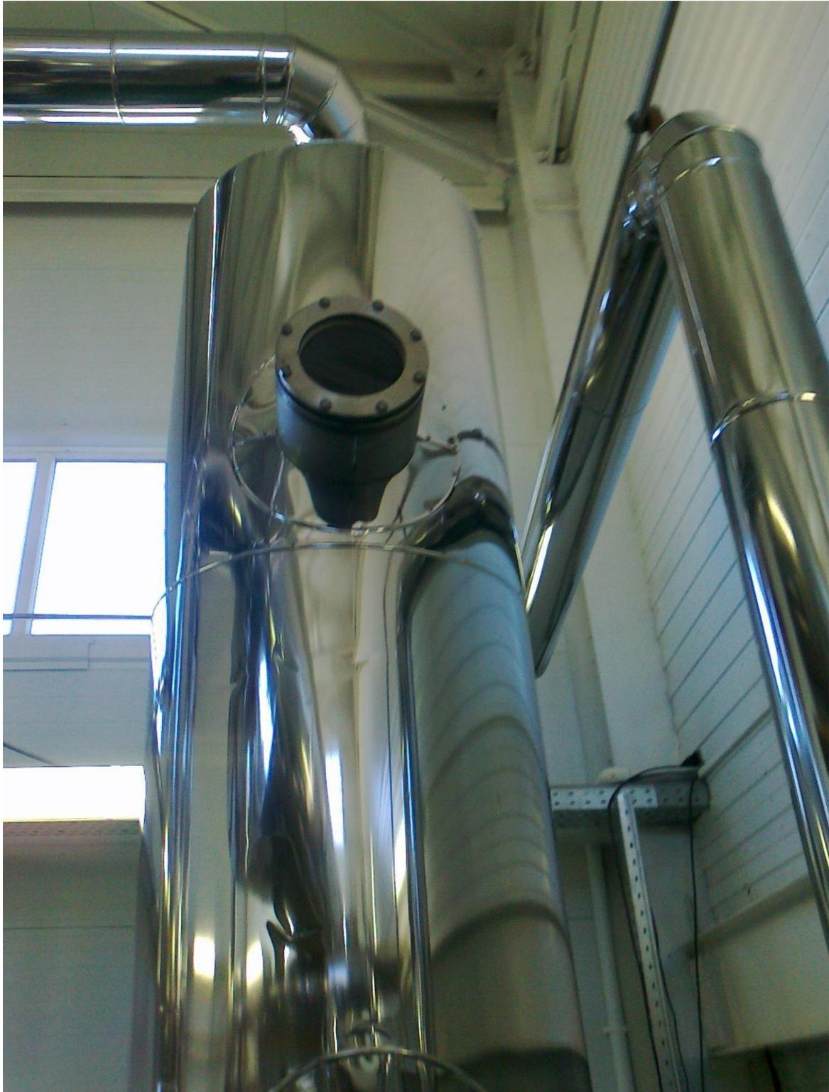
Деаэратор предназначен для деаэрации животных жиров при непрерывной дезодорации. Аппарат изготовлен из нержавеющей стали.
