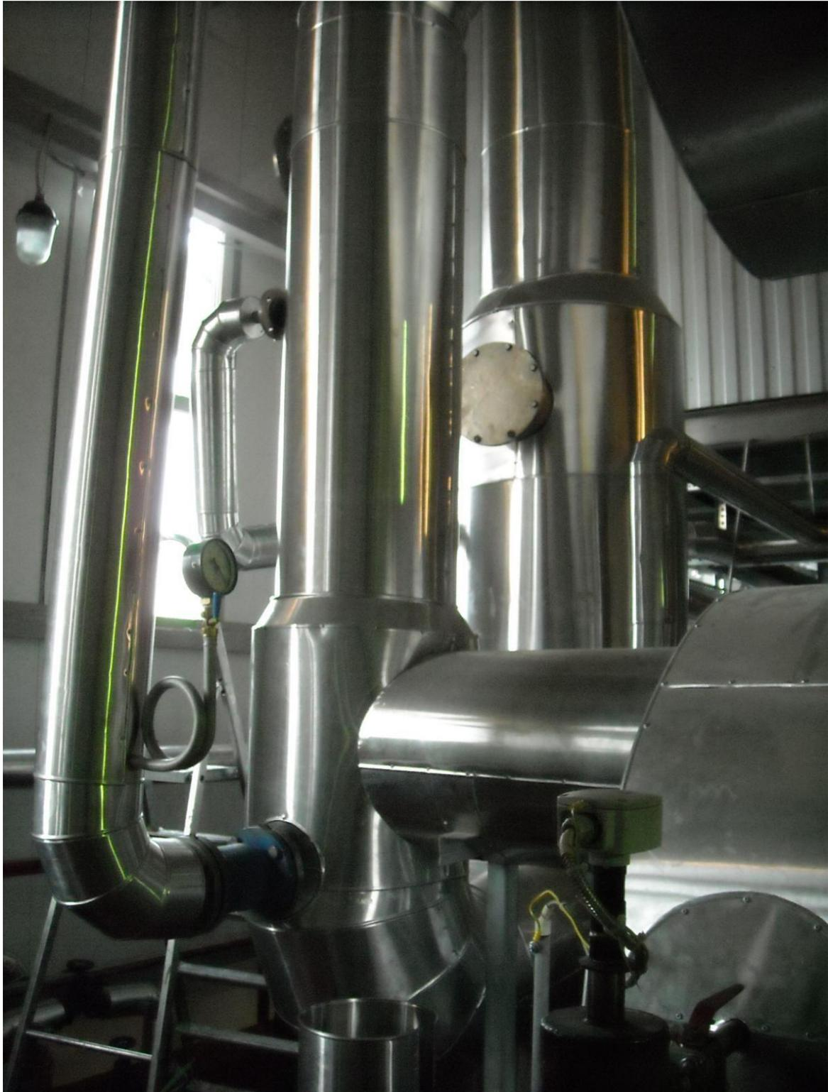
Скруббер предназначен для улавливания паров летучих веществ. Аппарат изготовлен из кислотостойкой нержавеющей стали. Снабжен змеевиком, обогреваемым глухим водяным паром.
