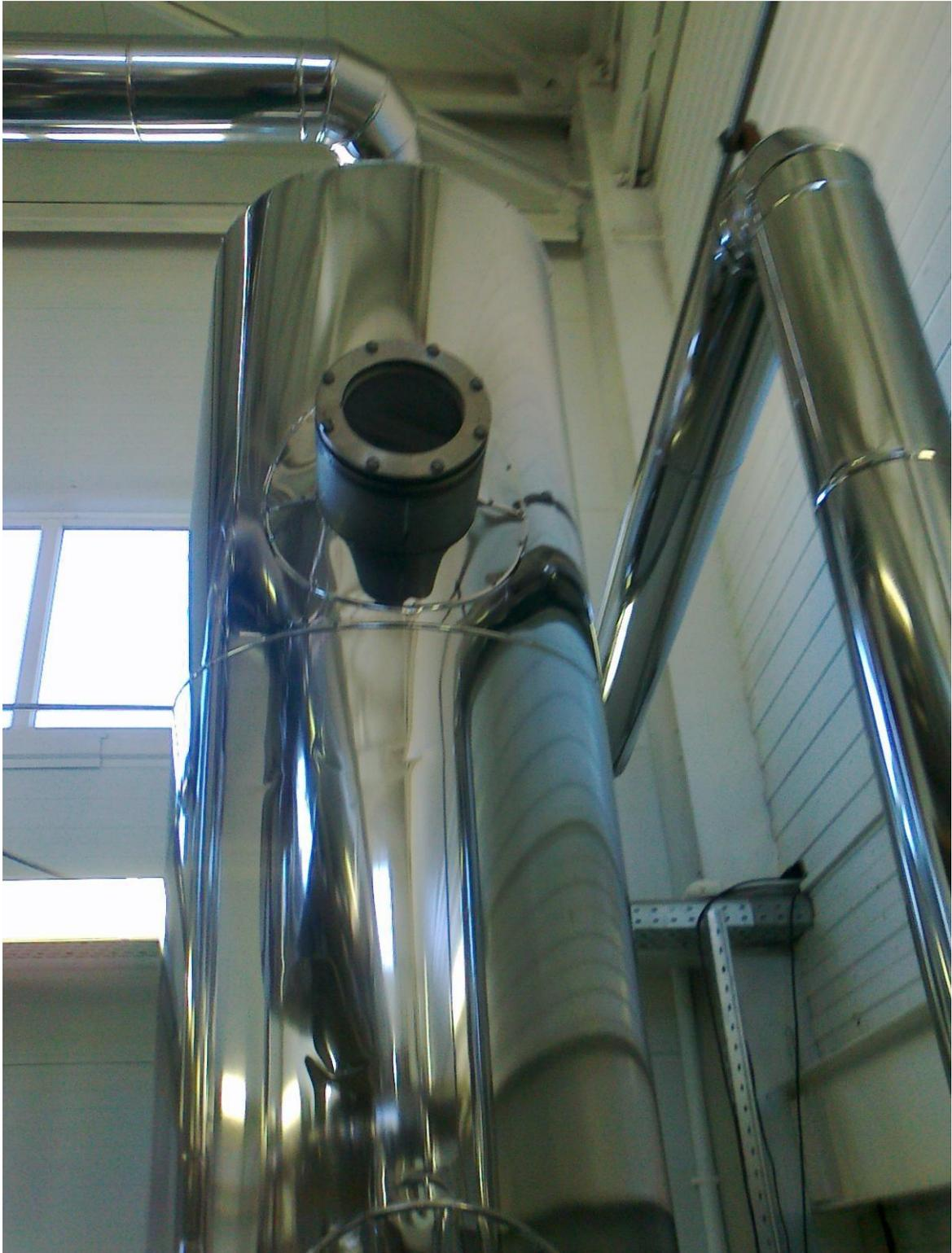
Предназначен для деаэрации растительных масел. Аппарат изготовлен из нержавеющей стали.
